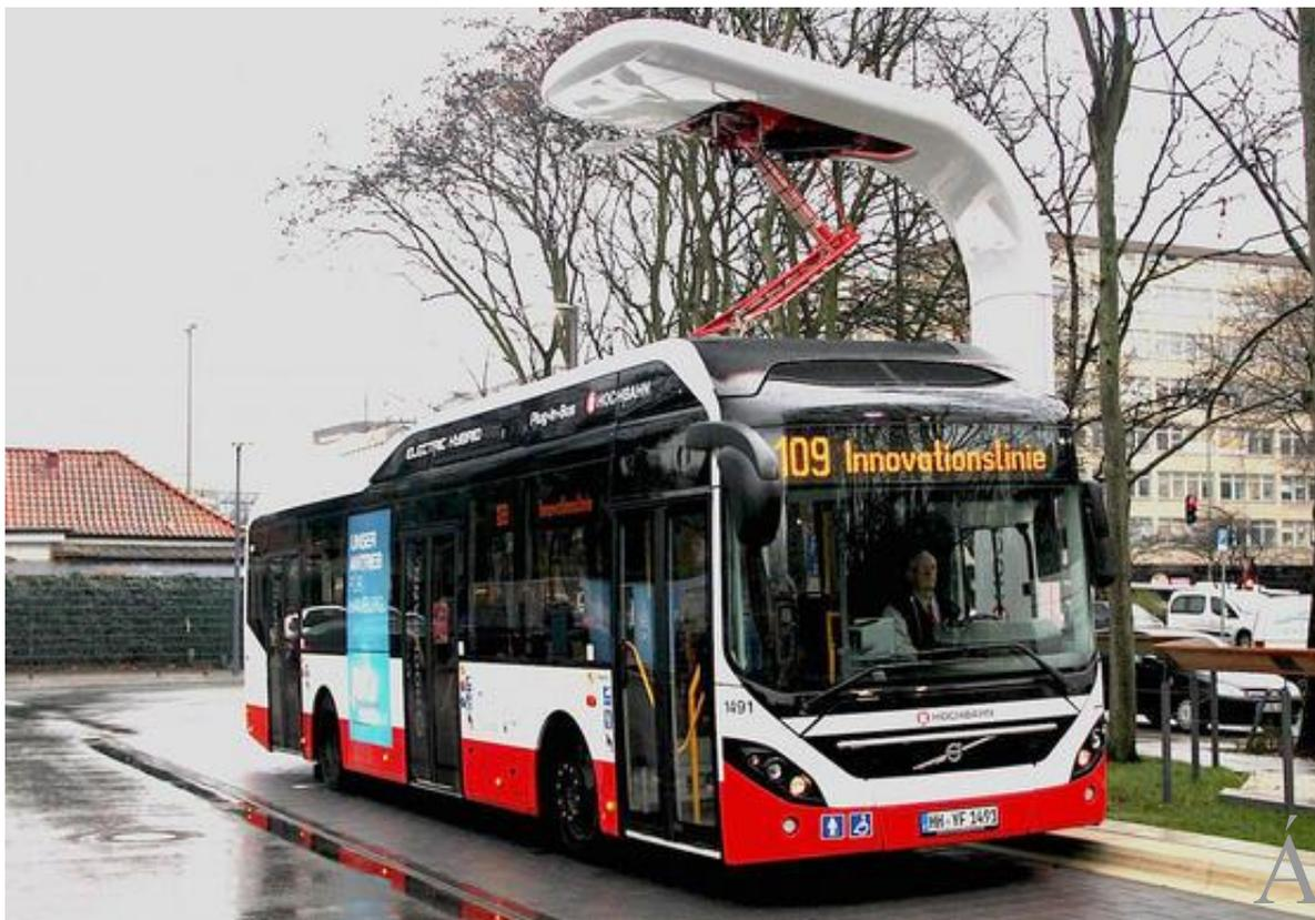
**In der Hamburger Innenstadt fährt der Elektro-Hybridbus 7900 von Volvo. Die Ladestationen von Siemens haben eine Ladekapazität von bis zu 300 Kilowatt.**
