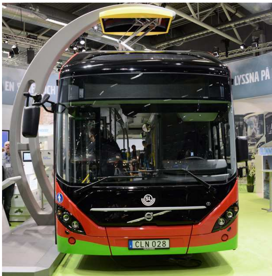
På Persontrafik visade Volvo den första av de åtta laddhybrider Volvo 7900 Electric Hybrid som ska gå i ett elbussprojekt i Stockholm. Bågen ovanför bussen är en av de laddstationer som ska finnas på linjens ändhållplatser. Foto: Ulo Maasing.
