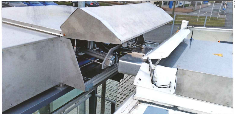
Abb. 5: Gesteckte Kopplungsvorrichtung, vom Busdach aus zum Bus blickend, noch ohne die spätere Verkleidung.
