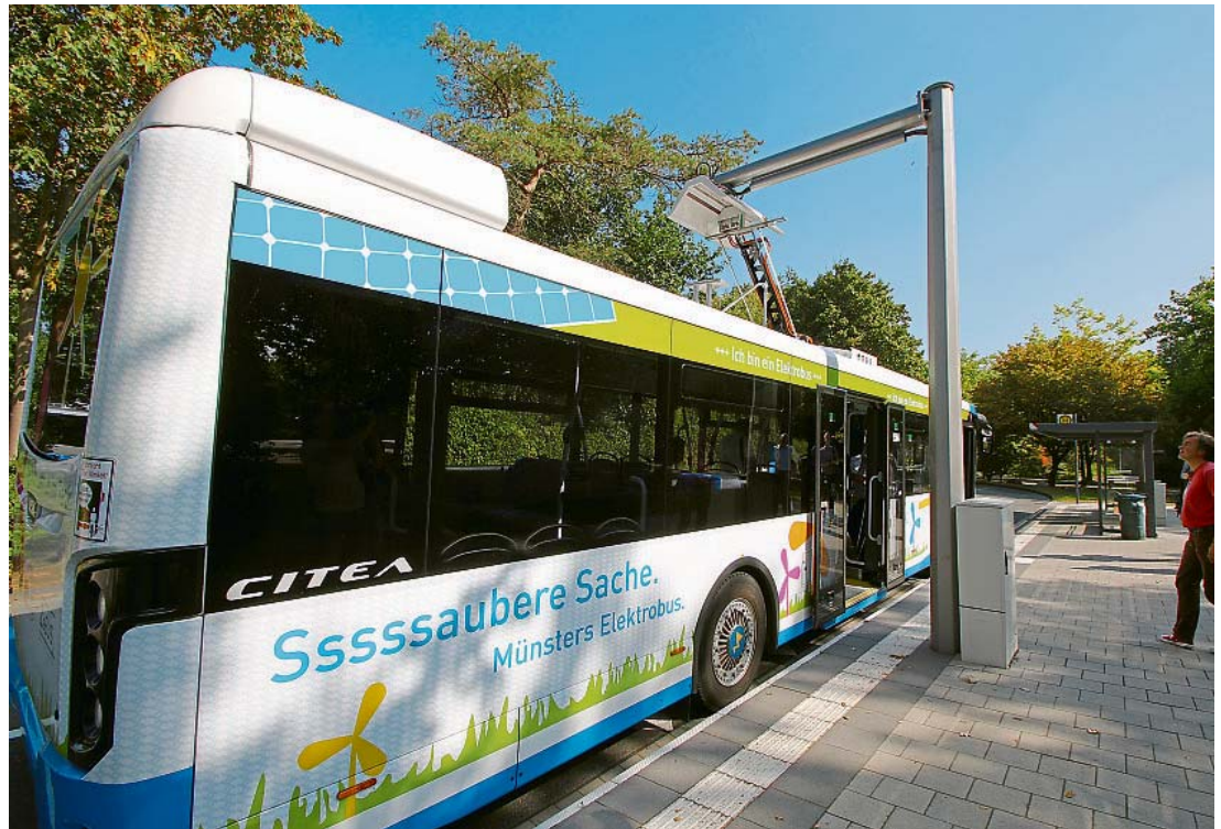
Die Elektrobusse sind mit Dachstromabnehmern ausgestattet, die an den Endhaltestellen (wie hier am Zoo) ausfahren und über einen Masten mit einer Ladestation verbunden werden. Innerhalb von acht Minuten sind die Batterien dann wieder voll. Foto: hpe
