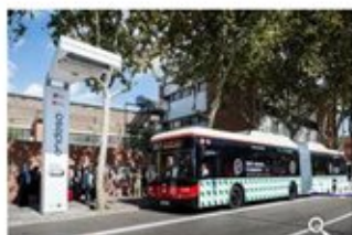
Uno de los nuevos autobuses que circularán por Barcelona en la estación de carga por Pantógrafa
