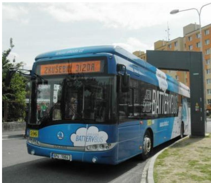
Typ Škoda PERUN HP 26BB představuje verzi elektrobusu Škoda PERUN vyvinutou pro potřebu průběžného dobíjení během dne (jeho „dvojče“, elektrobus Škoda PERUN HE 26BB, je naproti tomu konstruován jako tzv. noční elektrobus s průměrným dojezdem na jedno nabítí 150 km, čemuž odpovídají odlišné dílčí parametry – podrobnosti viz **ve studii „E-mobilita v MHD“**). Provoznímu režimu s průběžným dobíjením je přizpůsobena i konstrukce vozidla a jeho osazení trakčními bateriemi.
